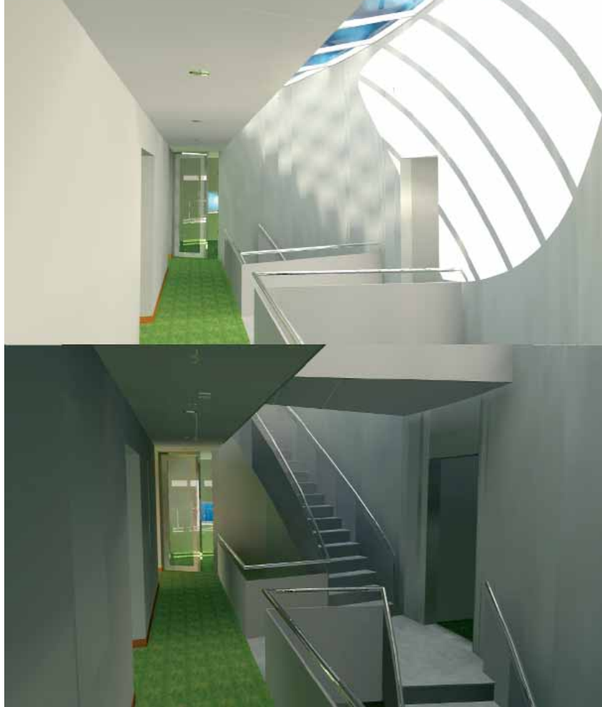
Lichts simulatie van trappenhuis om opwarming van zware betonwand door directe zonnestraling en daardoor oververhitting te illustreren.
